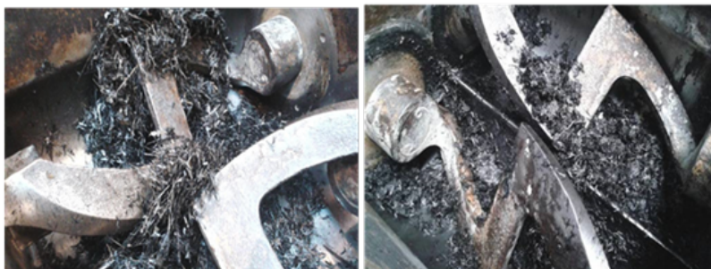
Proceso de mezclado del triturado de carbono con la formulación de resina definida
